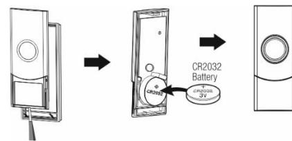
Rys. 3 Montaż przycisku / Fig. 3 Installation of transmitter / Abb. 3 Montage der Taste
